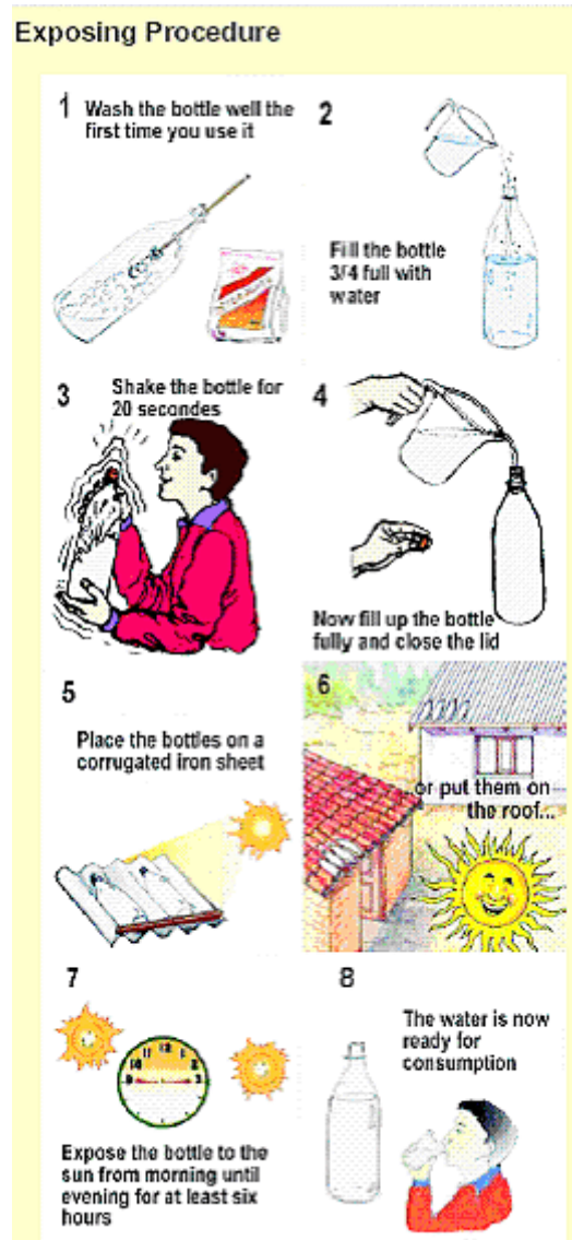
Figure D.8. SODIS Procedure (SANDEC, 2002)
